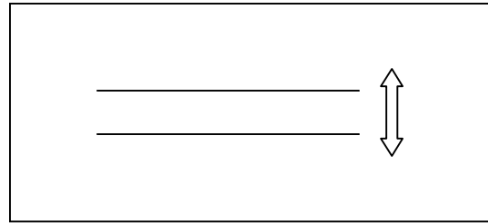
Figuur 5. Het verticale trilprincipe, waar men gelijktijdig een opwaartse kracht rechts en links oplegt.
